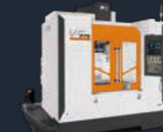
Broche entraînement courroie jusqu' à 10000 t/mn Glissières prismatiques disponibles
