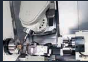
Fraisage/Tournage par axe B outil en broche
