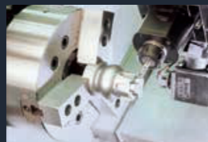
Broche avec entraînement par courroie disponible avec axe C
