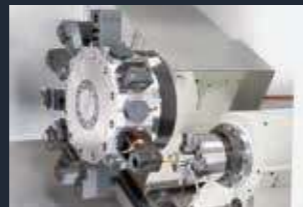
Moteur Broche disponible avec axes C/Y et broche secondaire
